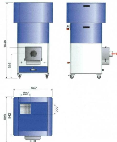
\* Übergang  $\varnothing 120$  bis  $\varnothing 200$  mm
